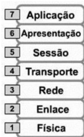
Figura 7: Camadas do modelo OSI
