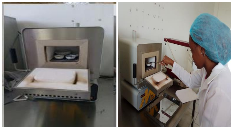
Figura 9: Determinação do teor de sólidos Fixos
