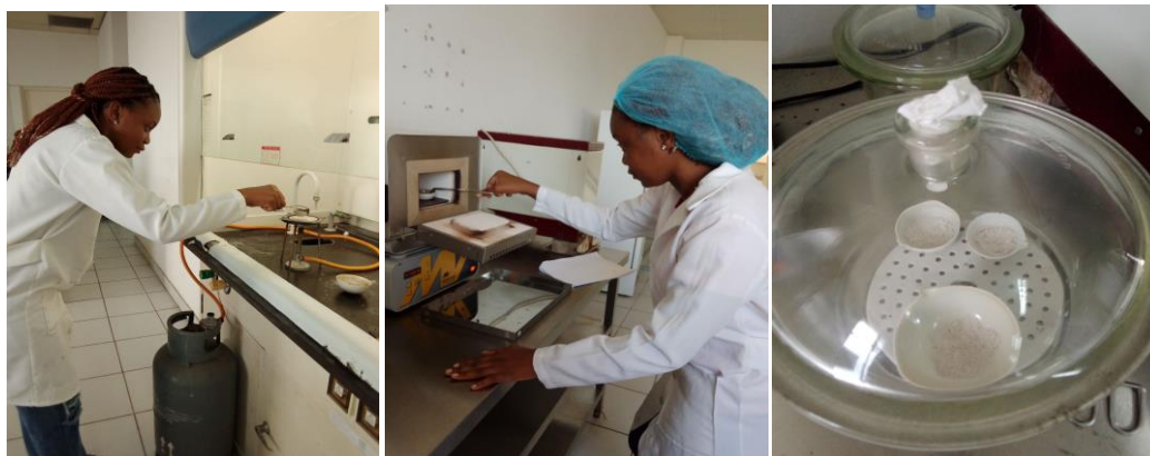
Figura 7: Determinação do teor de cinzas
