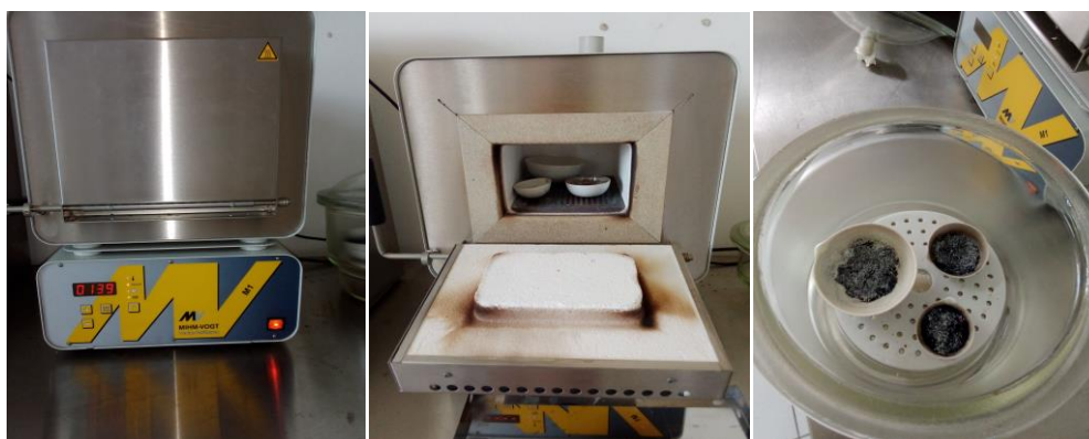
Figura 8: Determinação do teor de sólidos totais
