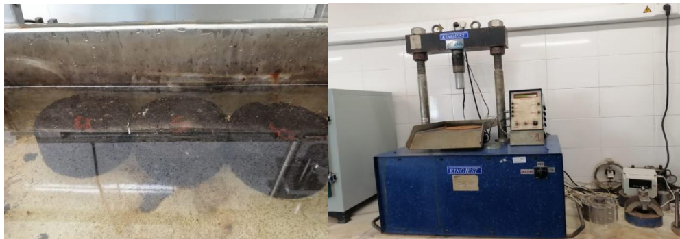
Figura 18: realização do ensaio de resistência com prensa.
