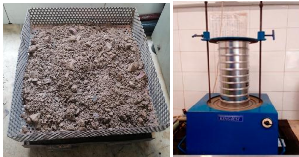
Figura 15: realização da análise granulométrica com recurso a um vibrador eléctrico.
