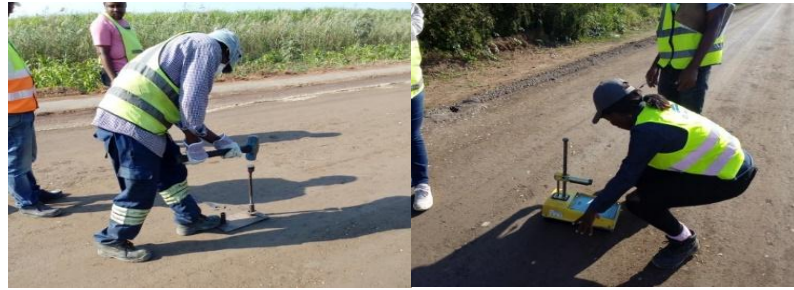
Figura 13: Ensaio de compactação in situ.
