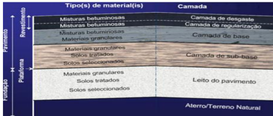
Figura 3: Estrutura de um pavimento flexível. (REIS, 2009).
