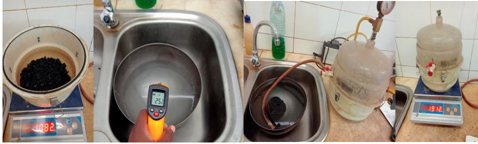
Figura 16: realização do ensaio de baridades com uso do picnómetro.
