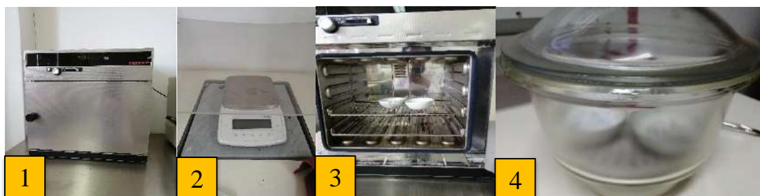
Figura 11: Processo de determinação do teor de humidade nas amostras de papel, papelão e algodão.
