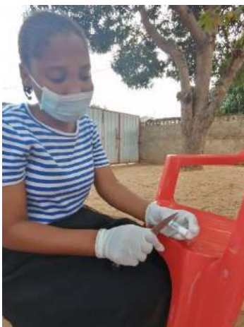
Figura 8: Preparação das amostras-Remoção de etiquetas de papel dos resíduos plásticos.
