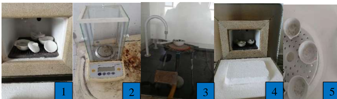
Figura 16: Processo de determinação do teor de matéria volátil em amostras de plástico.
