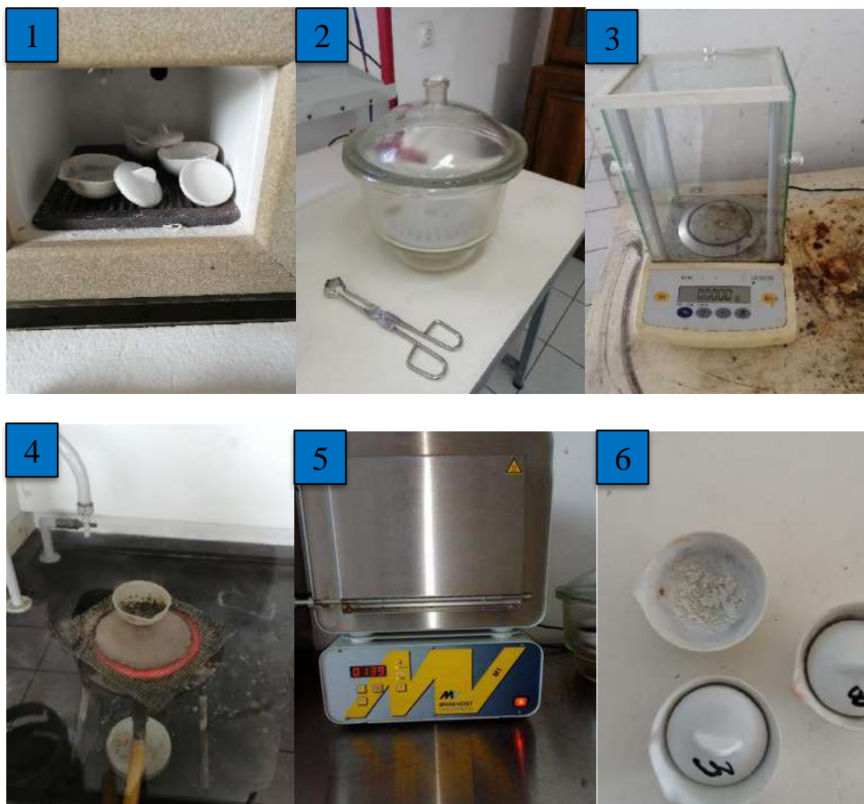
Figura 17: Processo de determinação do teor de cinzas nas amostras de plástico.
