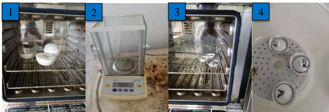
Figura 15: Processo de determinação do teor de humidade em amostras de plástico.
