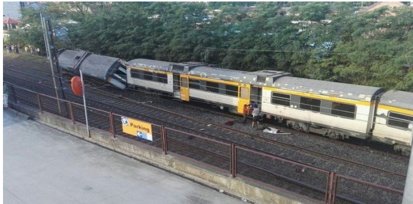
Figura 25 - Descarrilamento com adornamento (Fonte: Franzão, 2018)
