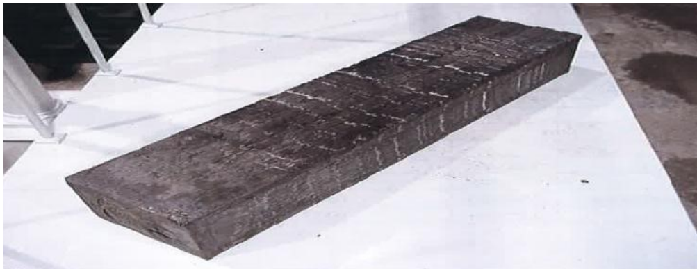
Figura 9: Travessa de material sintético (Fonte: Rosa, 2012, p. 245)
