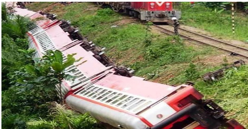
Figura 26 - descarrilamento com tombamento (Fonte: Franzão, 2018)
