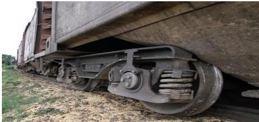
Figura 24 - Descarrilamento (Fonte: Franzão, 2018)
