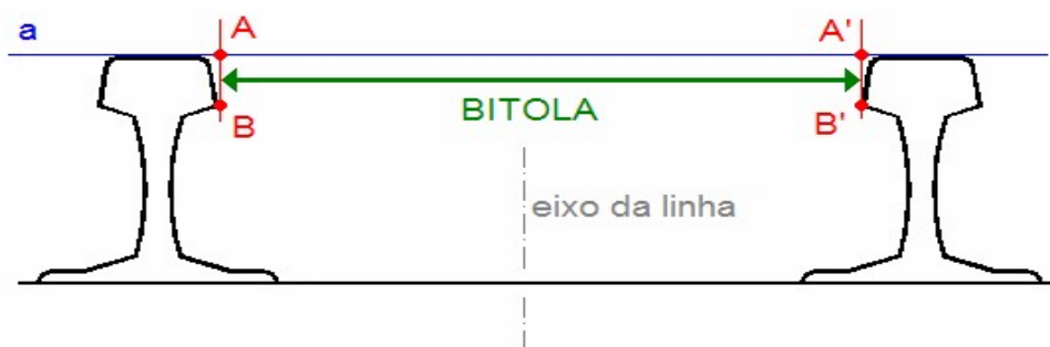
Figura 11: Desenho esquemático de Bitola (Fonte: Coimbra, 2008)
