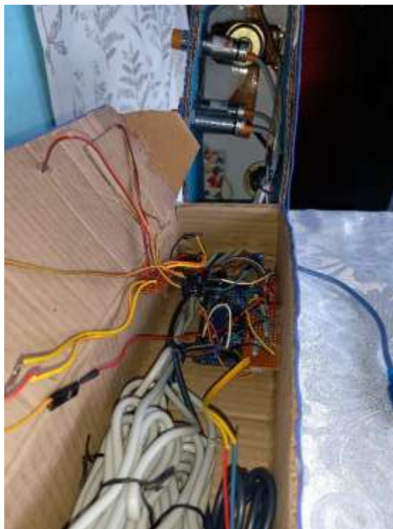
Figura 19: Montagem da estrutura da lixeira e interligação dos componentes electrónicos através do processo de estanhagem.
