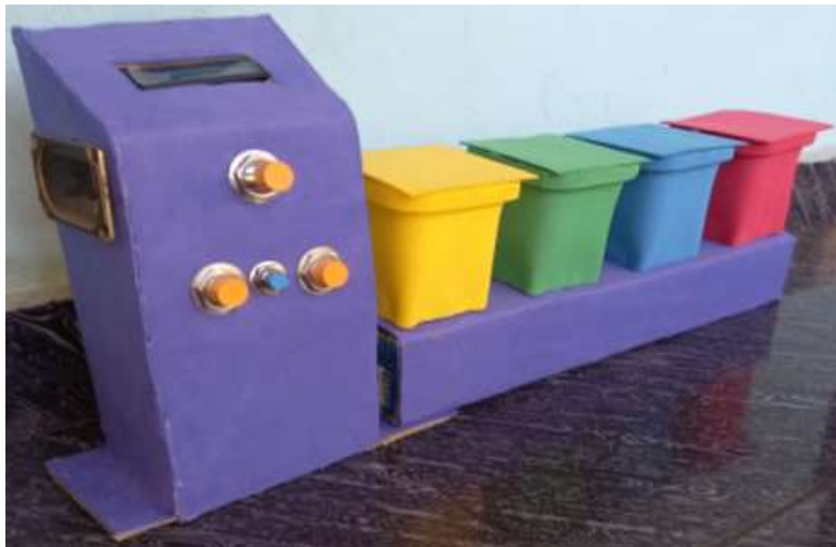
Figura 15: Sistema electrónico de educação sobre a deposição correcta e separação automática de resíduos sólidos para as lixeiras dos Laboratórios de Ensino e de Pesquisa FCNM da UP Maputo na sua construção completa.
