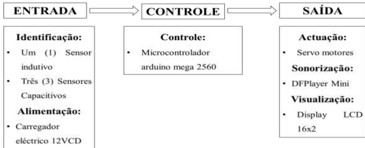
Figura 13: Diagrama de blocos de um sistema electrónico de educação sobre a deposição correcta e separação automática de resíduos sólidos para as lixeiras dos Laboratórios de Ensino e de Pesquisa FCNM da UP Maputo.
