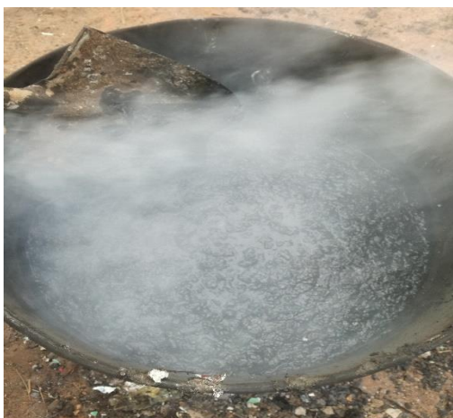
Figura 25 - Apresentação da característica do PET aos 600°C. Fonte: autor, 2022
