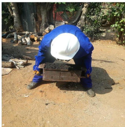
Figura 30 - Compactação manual por gravidade. Fonte: autor, 2022
