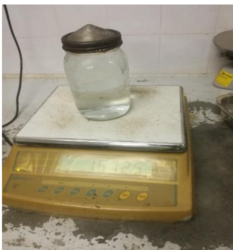
Figura 21 - Picnómetro/recipiente contendo água. Fonte: autor, 2022
