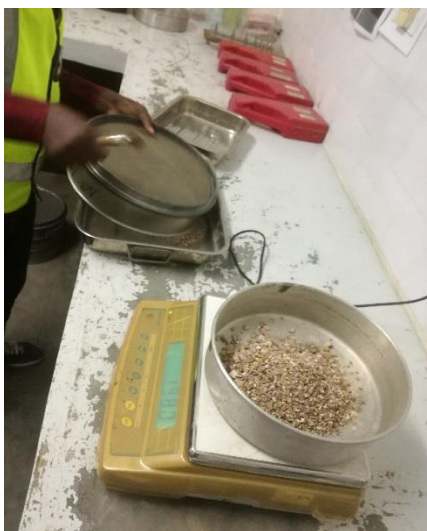
Figura 19 - Pesagem dos materiais retidos. Fonte: Autor, 2022
