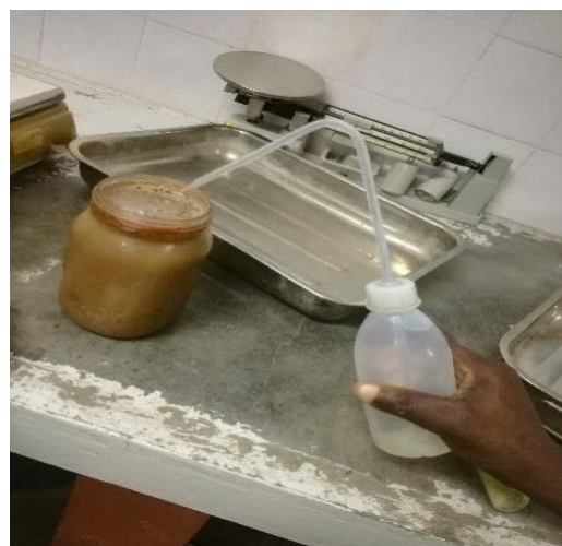
Figura 22 - Adição da água no Picnómetro contendo o agregado. Fonte: autor, 2022
