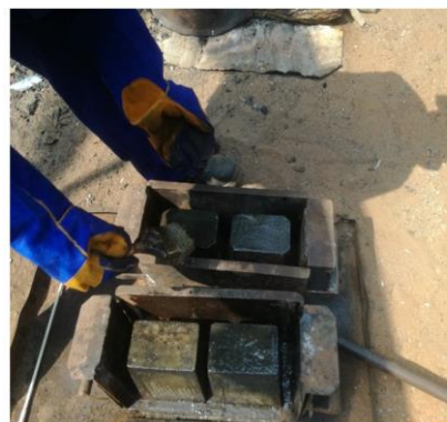
Figura 27 - Aplicação do óleo queimado no moldes. Fonte: autor, 2022.
