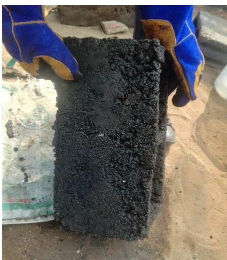
Figura 36 - Resultado do bloco em Mau estado apresentando porosidade. Fonte: autor, 2022.
