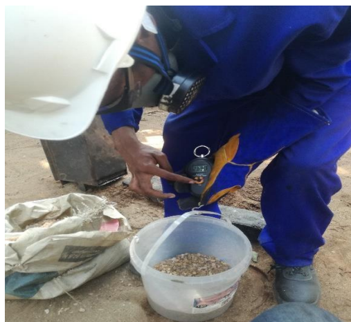
Figura 26 - Dosagem e pesagem do material. Fonte: autor, 2022.
