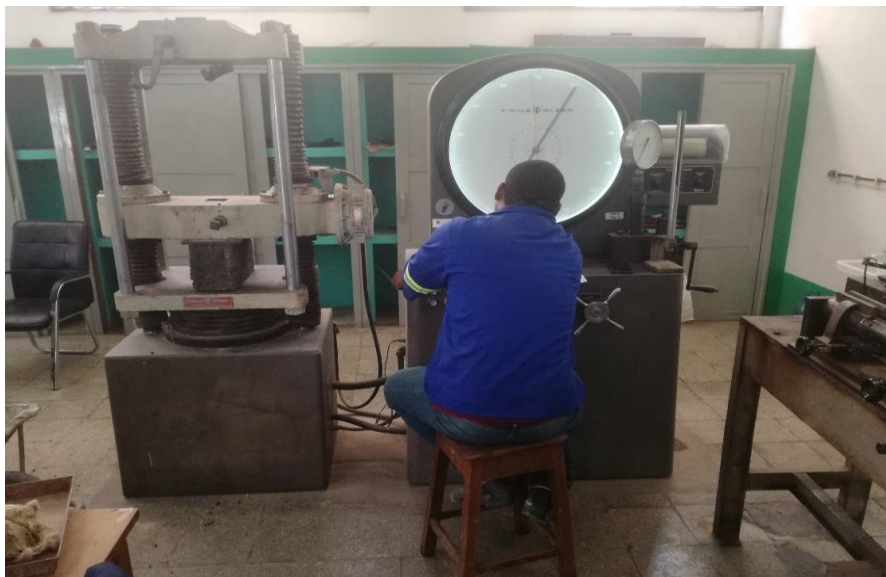
Figura 32 - Apresentação do ensaio da resistência a compressão na prensa Tinius/ Olsen Merrimack College de 1954. Fonte: autor, 2022.
