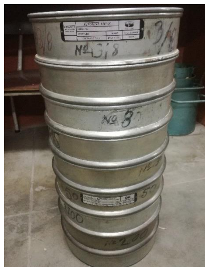
Figura 20 - Agitação manual dos agregados através da série de peneiros. Fonte: Autor, 2022.
