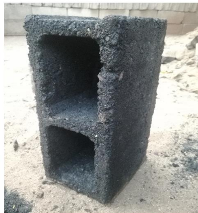
Figura 29 - Apresentação do bloco produzido com plástico reciclado. Fonte: autor, 2022.
