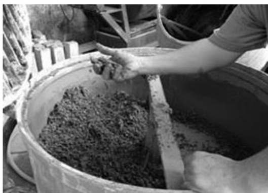
Figura 5 - PET triturado em processo de mistura com demais agregados. Fonte: (Barreto, J.M.L.; Costa, H.N.; Cândido, L.F (2019)).
