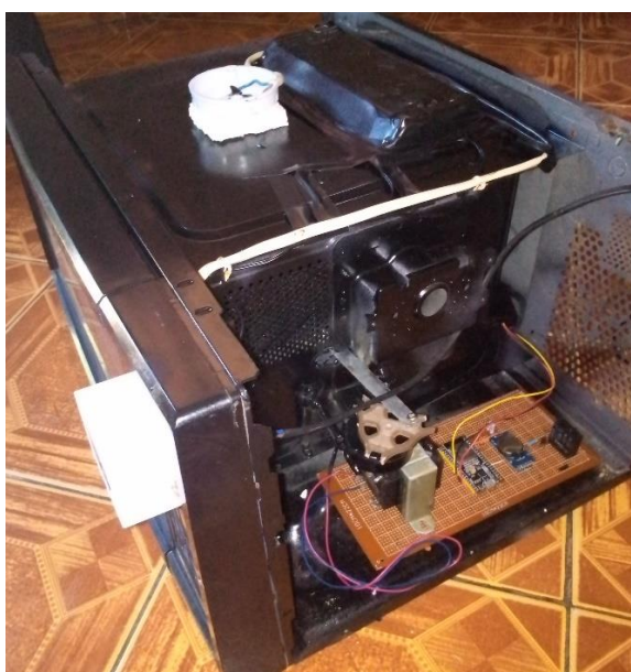
Figura 19: Circuito de monitoramento fixada na caixa de microndas
