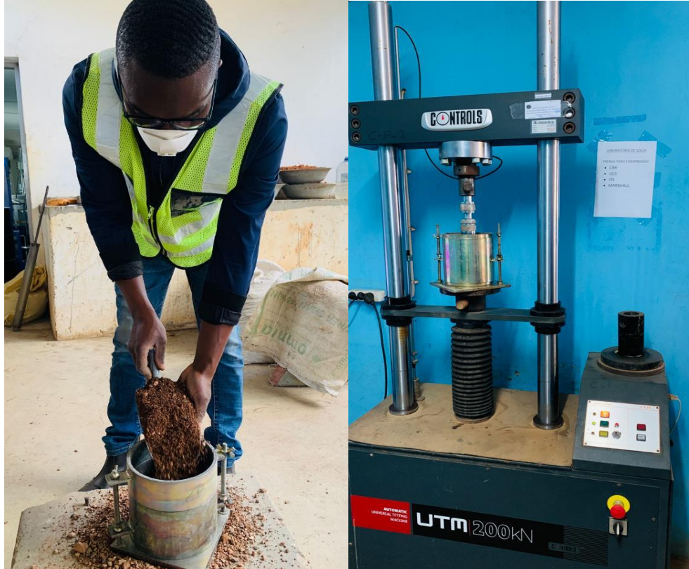
Figura 47. Processo de ensaio de CBR. (Autor 2023.)
