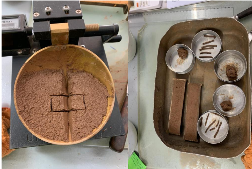
Figura 45. Processo de Ensaio de limite Atterberg. (Autor 2023.)
