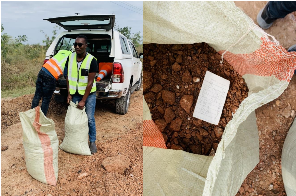
Figura 43. Colheita de Amostras Tout-Venant (Base existente). Km2+058. (Autor 2023.)
