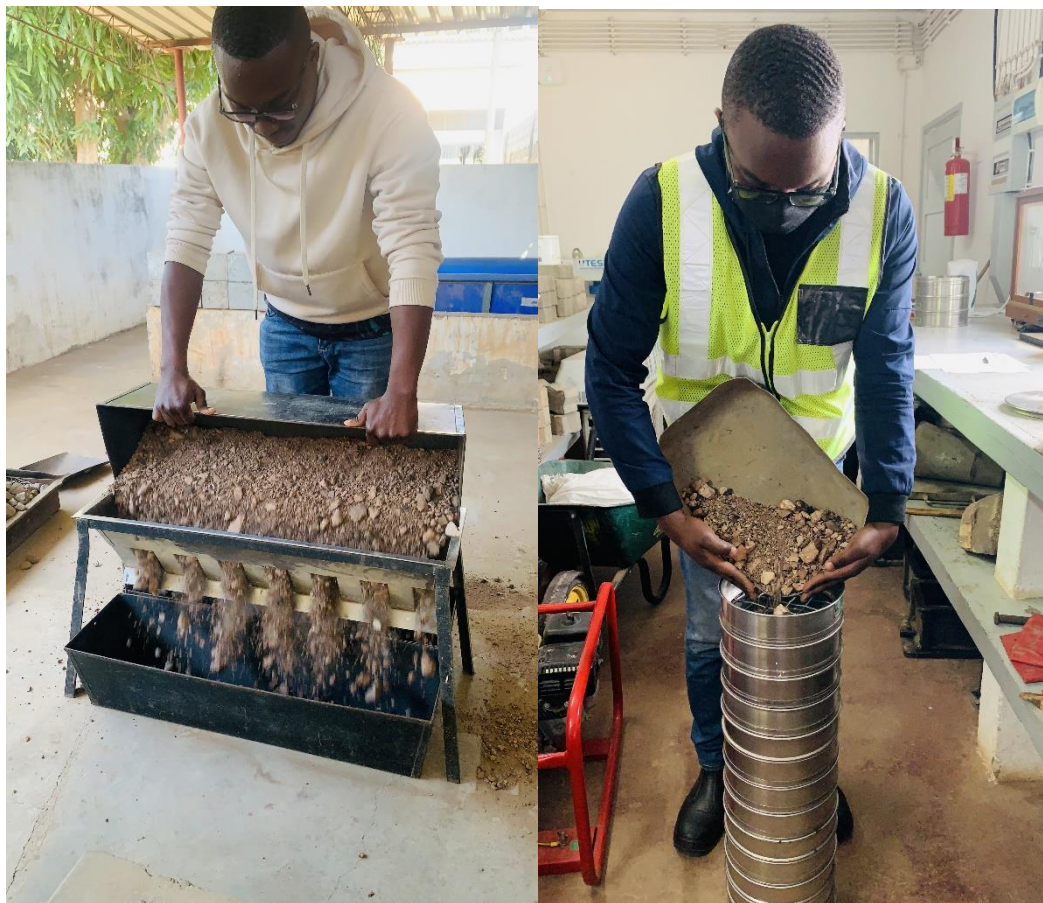
Figura 44. Processo Para análise Granulométrica. (Autor 2023.)
