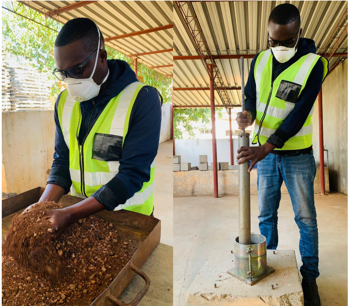
Figura 46. Processo de Ensaio de Compactação. (Autor 2023.)
