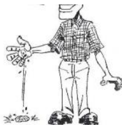
Figura 9: Teste rápido de humidade correcta da mistura da argamassa durante a produção de blocos
