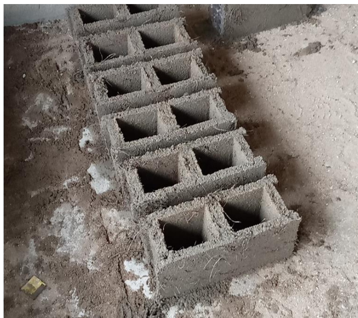
Figura 35: Bloco solo-cimento lote 2
