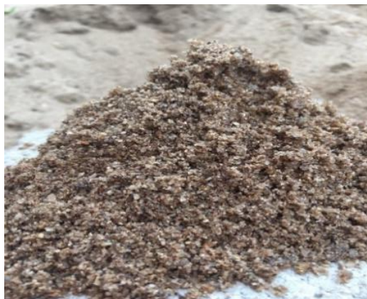
Figura 23: Areia grossa com dimensões de 2 a 4 mm, usada para a produção dos blocos de argamassa
