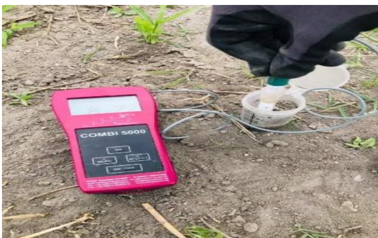
Figura 3: Leitura do valor de pH e CE no estrato solo/água na proporção 1:2.5
