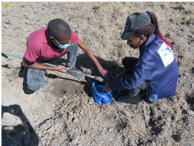
c) Recolha de amostra do solo em diferentes pontos em formato de W, para o laboratorio
