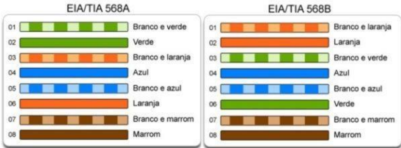
Figura 8: Combinação de cabo de par trançado
