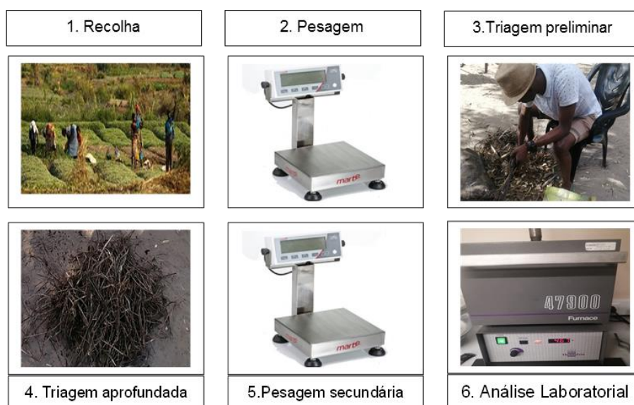
Figura 7: Processo de recolha, triagem e quantificação de RSA.
