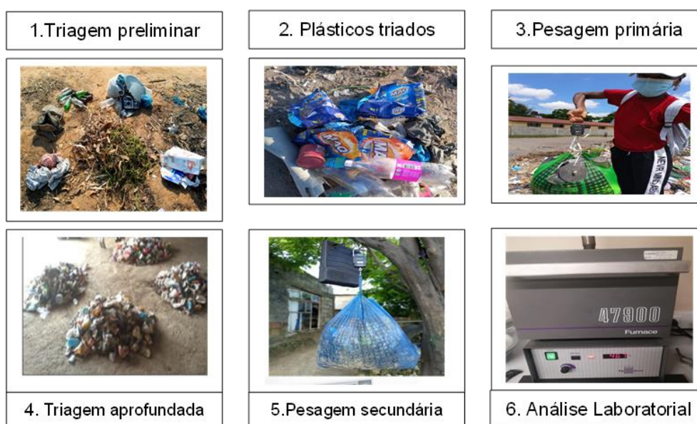
Figura 5: Processo de recolha, triagem e quantificação de RSU – plásticos.
