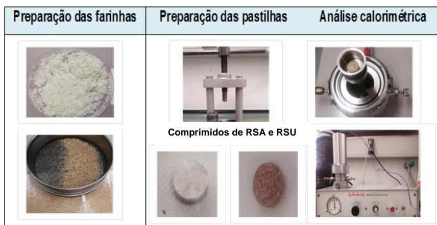
Figura 11: Protocolo de análise calorífica e energética dos RSA e RSU.
