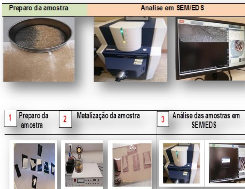
Figura 10: Protocolo de análise elementar e estrutural dos RSA e dos resíduos plásticos.
