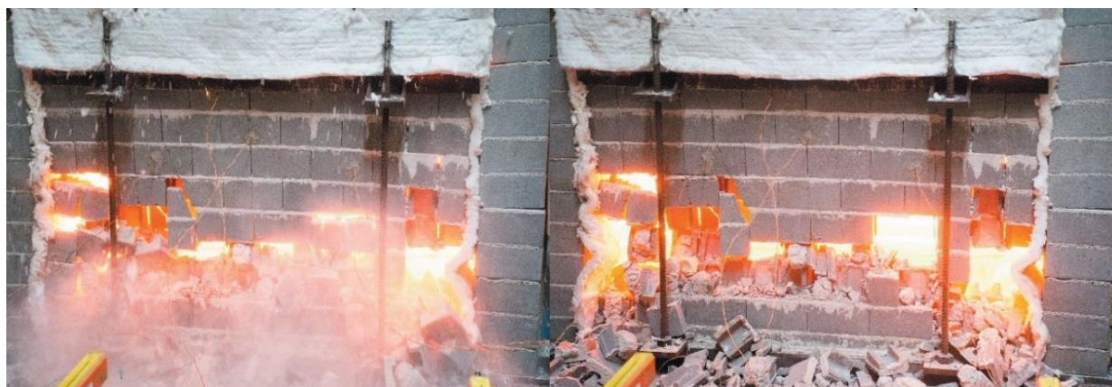
Anexo 9: Provete 6 - Sequência de colapso estrutural - 2 de 2 (Fonte: LOPES, 2017)
