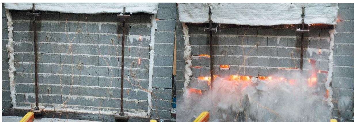
Anexo 8: Provete 6 - Sequência de colapso estrutural – 1 de 2 ( Fonte: LOPES, 2017)
