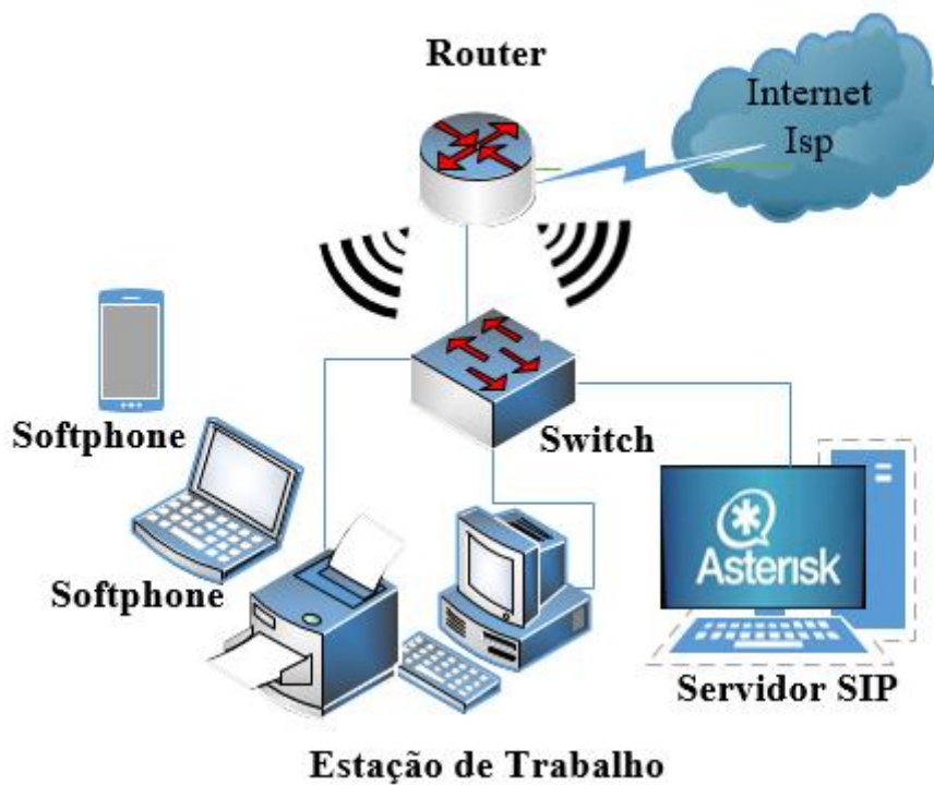
Figura 10: Topologia proposta: integração do servidor SIP ao backbone de dados do CMCM.
