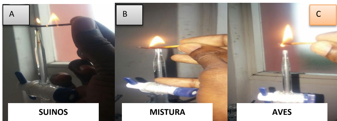
Figura 11: Teste de Combustibilidade do Bio Hidrogénio
