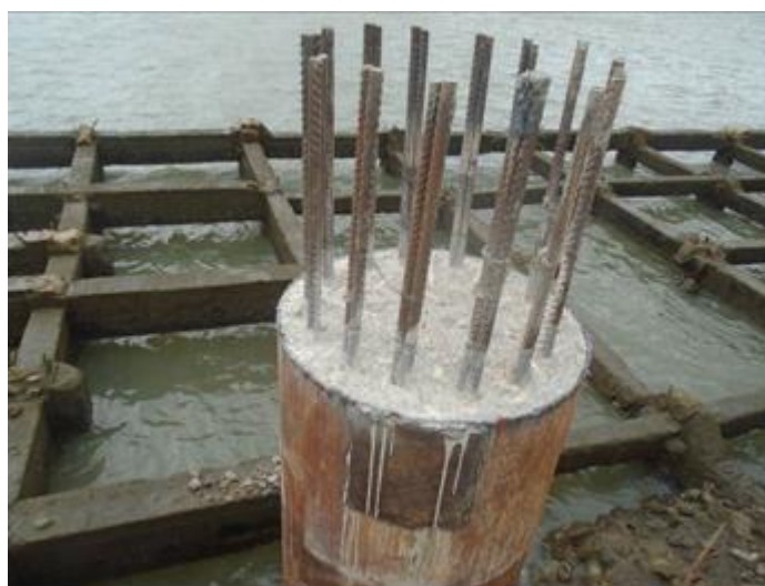
Figura 18: Estaca com Superfície Preparada para o ensaio (Fonte: Autor deste trabalho)
